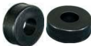
BUCHA GRAFITADA P/ CADEIRA DE RODAS ØE: 29,5MM ØI: 11,9MM ALT.: 10,8MM
